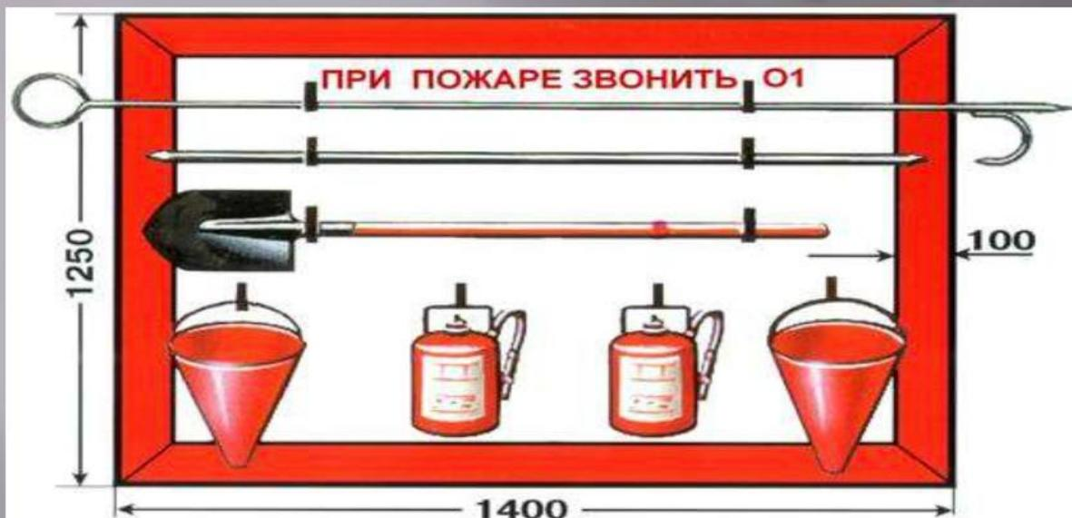
**ПРЕДНАЗНАЧЕН** для размещения первичных средств пожаротушения, немеханизированного инструмента и пожарного инвентаря в производственных и складских помещениях, не оборудованных противопожарным водопроводом и автоматическими установками пожаротушения, а также на территории предприятий, не имеющих наружного противопожарного водопровода, или при удалении зданий (сооружений), наружных технологических установок на расстояние более 100 м от наружных пожарных водоемисточников.
